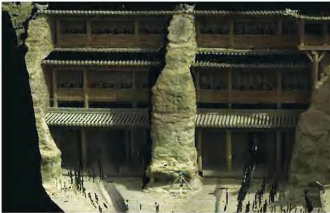
图 3 三维激光扫描仪获取云冈石窟第 7、8 窟彩色纹理点云
